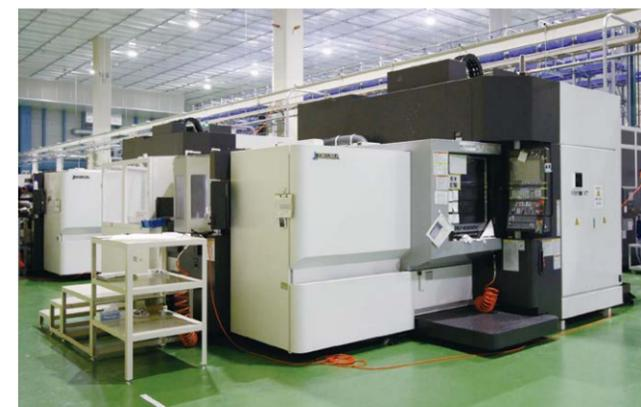
幾何誤差を短時間で計測・自動補正をする「ファイブチューニング」を搭載した「MU-6300V」。時間のかかる面倒な作業を大幅に削減。
