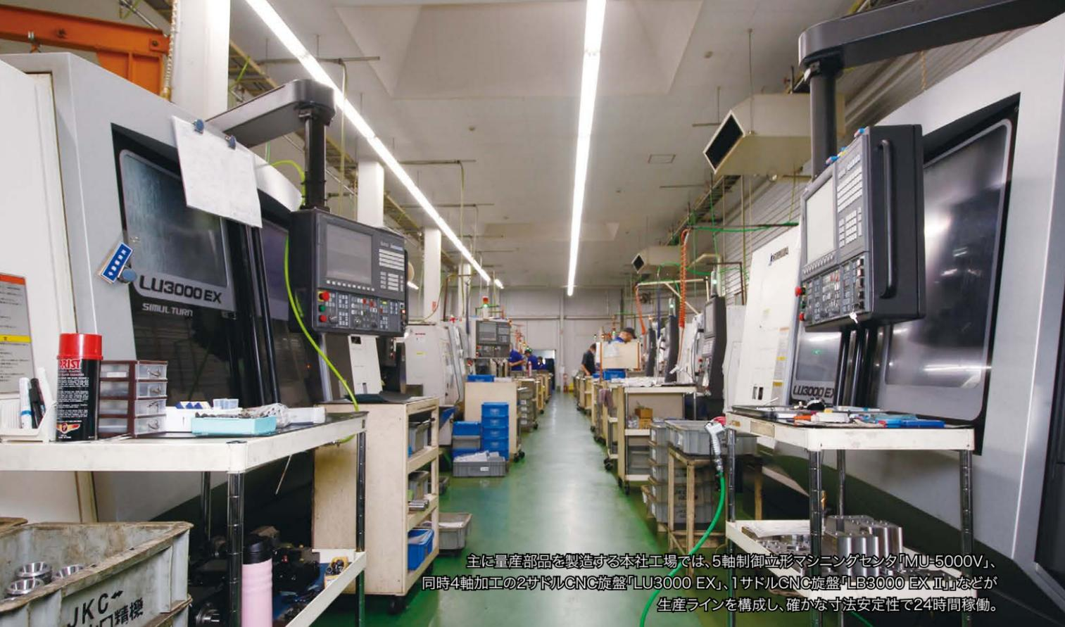
主に量産部品を製造する本社工場では、5軸制御立形マシニングセンタ「MU-5000V」、同時4軸加工の2サドルCNC旋盤「LU3000 EX」、1サドルCNC旋盤「LB3000 EX II」などが生産ラインを構成し、確かな寸法安定性で24時間稼働。
