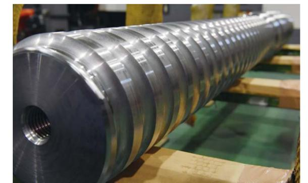
加工したボールねじは、納入先で焼入れ・研磨され、ボールを内蔵したナット部品を装着して完成品に。
