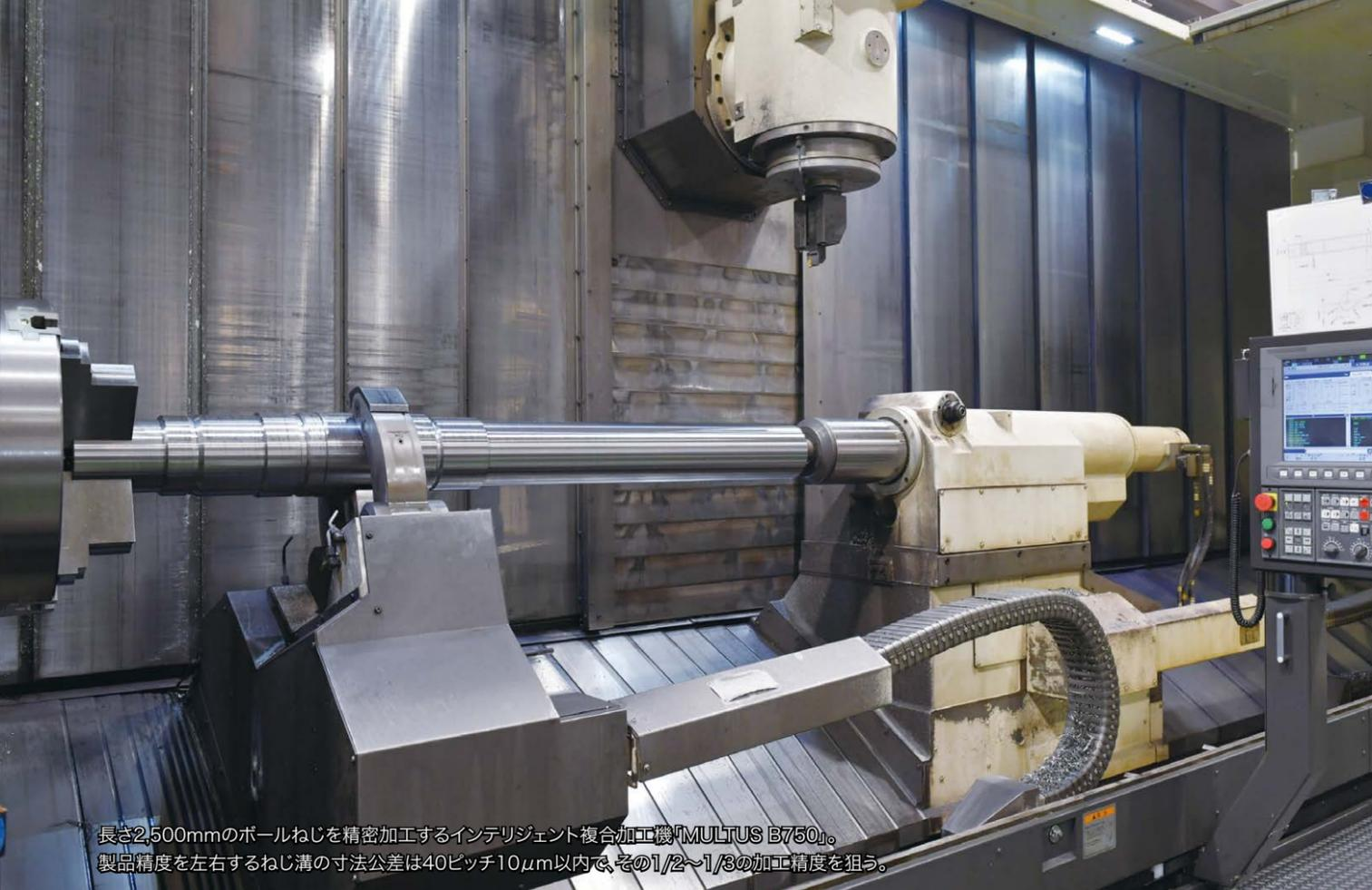
長さ2,500mmのボールねじを精密加工するインテリジェント複合加工機「MULTUS B750」。製品精度を左右するねじ溝の寸法公差は40ピッチ10μm以内で、その1/2~1/3の加工精度を狙う。
