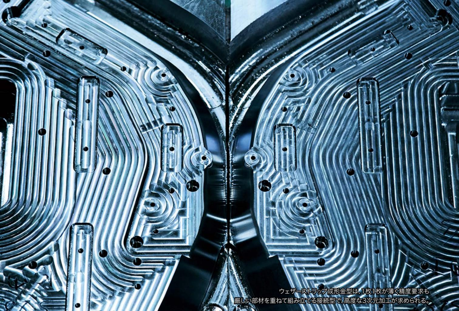
ウェザーストリップ成形金型は、1枚1枚が薄く精度要求も厳しい部材を重ねて組み立てる接続型で、高度な3次元加工が求められる。
