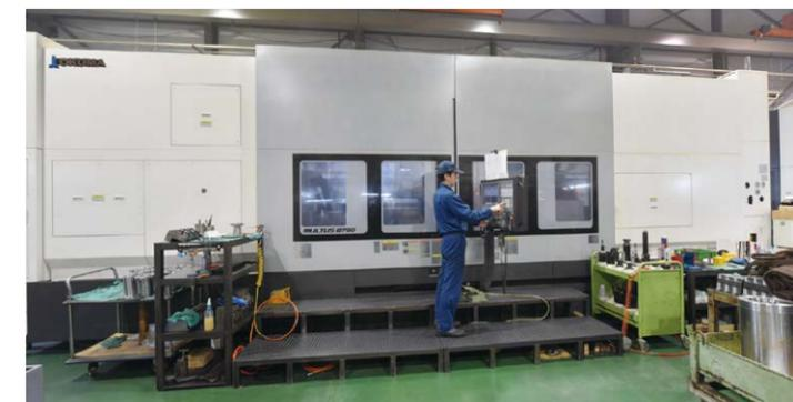
工場の中で圧倒的な存在感を放つインテリジェント複合加工機「MULTUS B750」。長さ3,000~4,000mmのワークの加工では、「加工ナビ」の活用が欠かせない。
