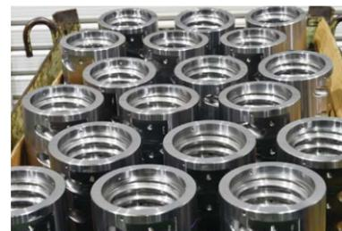
ボールねじに組み付けるナット部品。上は特殊な回転工具を活用した複合加工、下は旋盤で内径のねじ切りを、側面部はマシニング加工。
