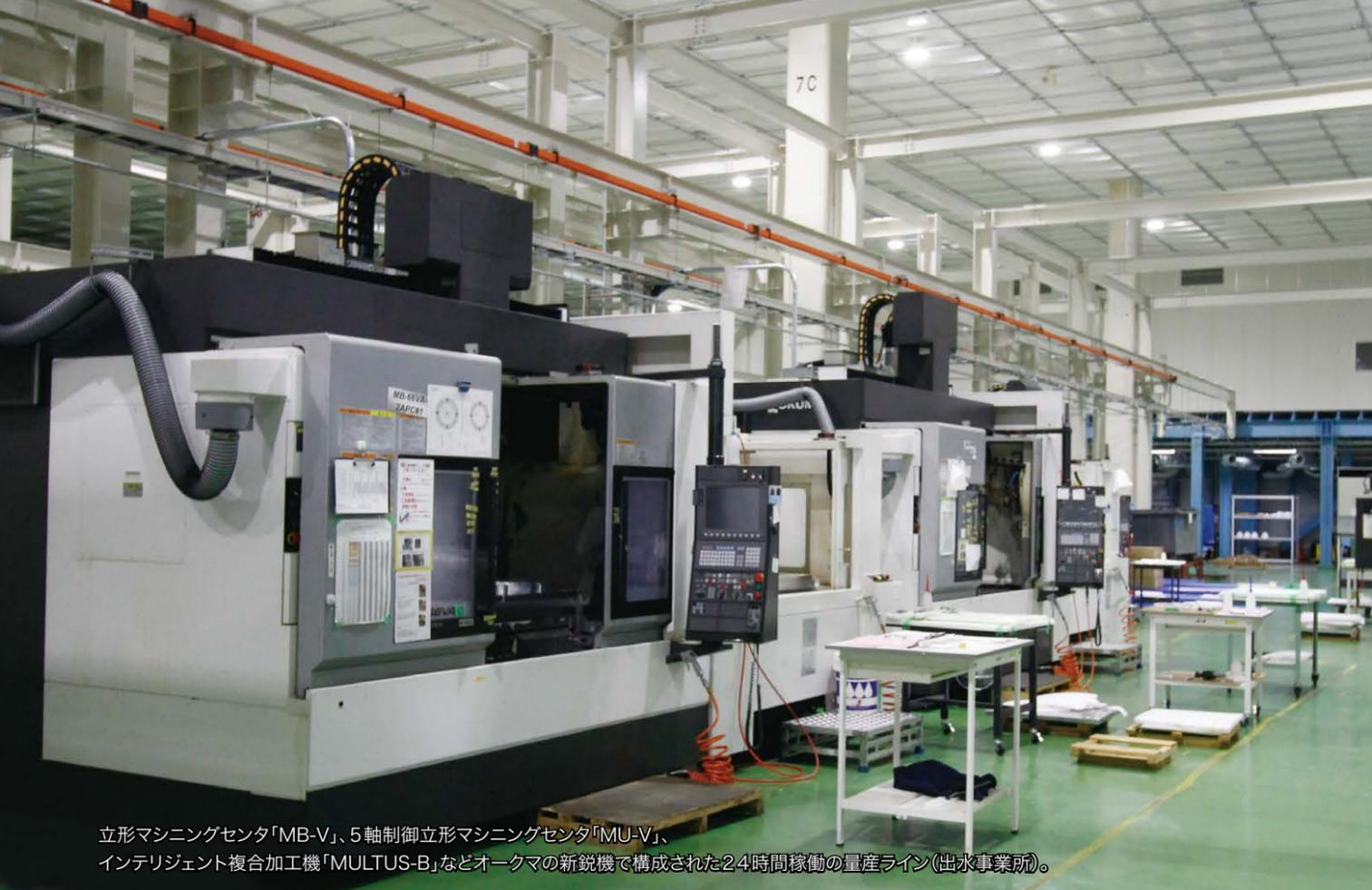
立形マシニングセンタ「MB-V」、5軸制御立形マシニングセンタ「MU-V」、インテリジェント複合加工機「MULTUS-B」などオークマの新鋭機で構成された24時間稼働の量産ライン(出水事業所)。
