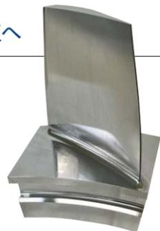
粘りがあり、硬いステンレスを削り出したテストタービンノズル。全長50mm、最大肉厚2mmと非常に薄く、要求精度は25μm。
