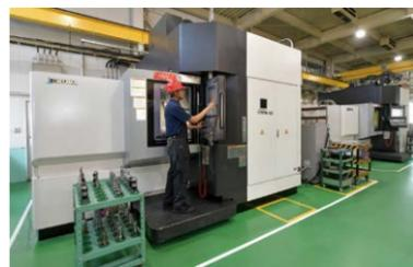
オペレータの作業性が良く、海外研修生からも「使いやすい」と好評の5軸制御立形マシニングセンタ「MU-6300V」
