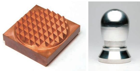
左:マシニングセンタで高さ6mmのバリのない四角錐を削り出したサンプル。
